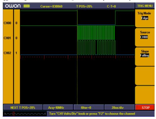
Fig.5-55: Edge trigger setting
