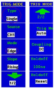
Fig. 5-19 Edge trigger menu
